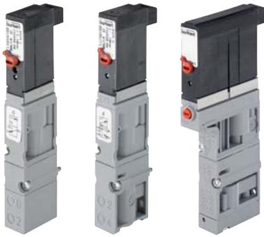
Die Pilotventile vom Typ 6524 und 6525 bestehen aus einem Vorsteuer-Wippenmagnetventil vom Typ 6104 und einem Pneumatiksitzenventil. Das Wirkprinzip erlaubt das Schalten hoher Drücke bei geringer Leistungsaufnahme und mit kurzen Schaltzeiten. Die Vorsteuerventile sind serienmäßig mit einer Handbetätigung ausgestattet.
