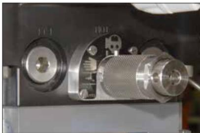
Рис. 6.1.1. Рукоять включения ручного дублёра SI3
