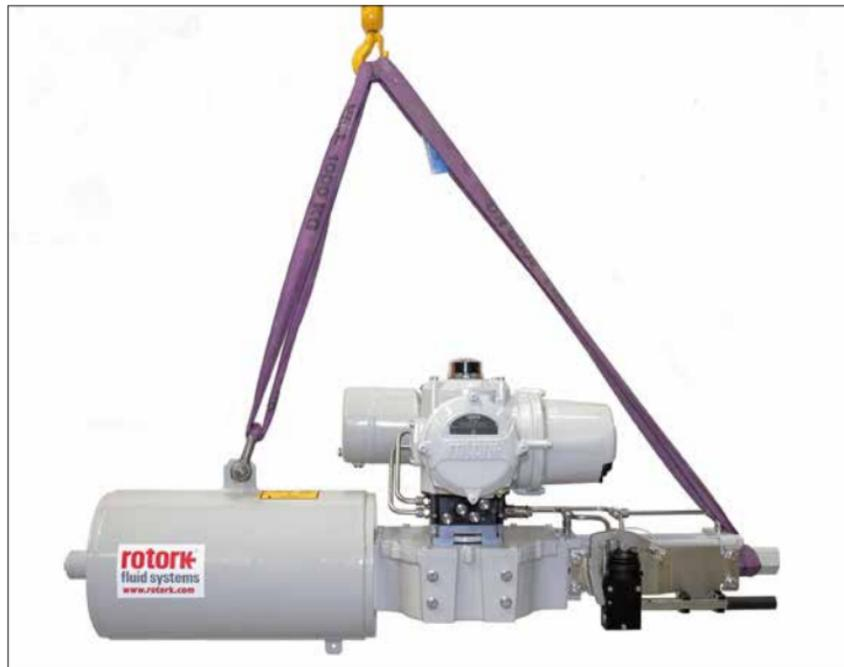
Рис. 4.1.1. Стропы закреплены за проушину и крышку стопорного болта гидравлического цилиндра.
