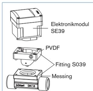
Das Durchflussmessgerät 8039 besteht aus einem Elektronikmodul und einem Flügelrad, welches auf dem Fitting montiert ist. Die Verbindung erfolgt über 4 Schrauben.
