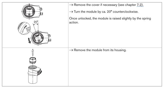
Fig. 7 : Removing the display module
