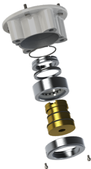
Assemblage embase d'effort F14 et F16 type A.
