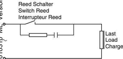
2) Ist der Reed-Kontakt an eine **kapazitive** Last angeschlossen (Glühlampe, Kondensator,...), werden seine Kontakte einem hohen Anschlagstrom unterworfen. Deshalb empfehlen wir, den Kontakt mittels einem Schutzwiderstand zu schützen (siehe folgende Abb. ).
