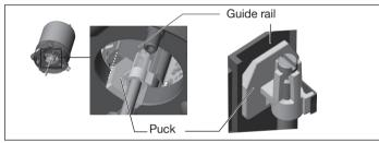
Fig. 15: Aligning the puck
