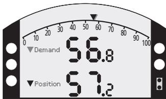
Mit der Rotork *Bluetooth*® Fernbedienung Pro kann jeder dieser Bildschirme auf Knopfdruck ausgewählt werden. Alternativ kann einer dieser vier Bildschirme als ständige Anzeige im Setup-Menü gewählt werden.
