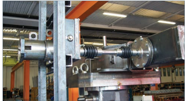
Приводной удлинитель из нерж. стали для разъема под моментные инструменты (ISO 13628-8).
