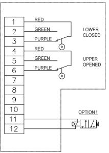
V5J012BB1C 30 V DC / 125V AC 100mA V5B210CB1C 250V AC 6A, DC 0,25A, 125V DC 0,5A, 24V DC 5A Ref.No. 60376
