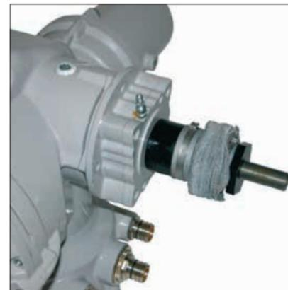
Fig. 6.6.2 IQML sans adaptateur de montage
