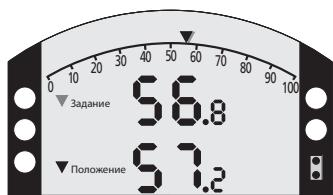
К каждому из этих экранов можно легко получить доступ, нажав на кнопки пульта настройки Rotork Pro с Bluetooth®. Как вариант, в меню настройки можно выбрать один из четырёх экранов для постоянного отображения.
