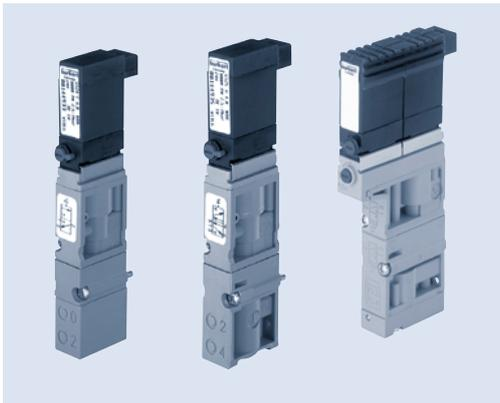
Las electroválvulas Tipo 6524 y 6525 están formadas por un cuerpo de válvula neumática montado en una válvula de pilotaje de balancín Tipo 6104. El principio del balancín permite la conmutación de altas presiones a un bajo consumo energético y unos rápidos tiempos de respuesta. Todas las electroválvulas están equipadas de serie con un modo manual.
