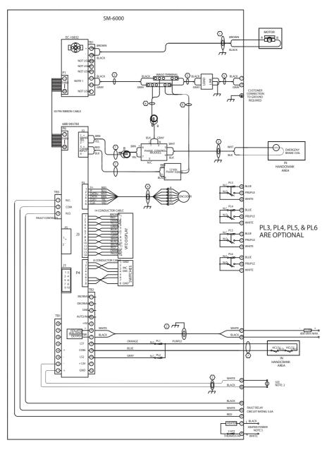
Figure 3.10. Typical SM6000-S2 Wiring Diagram
