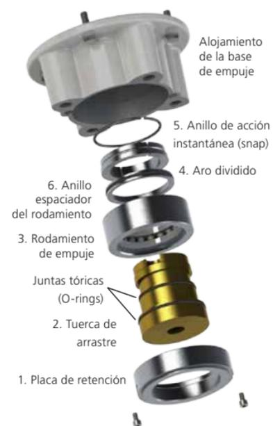
Fig. 5.1.3 Montaje de base F14 & F16
