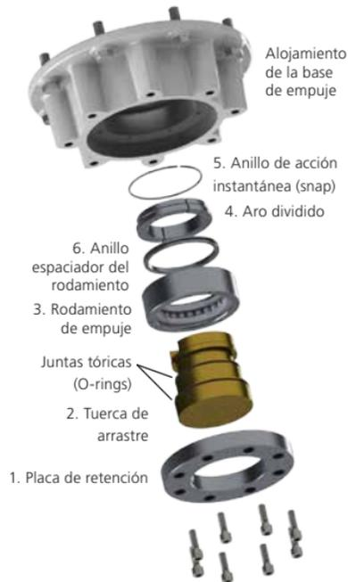
Fig. 5.1.4 Montaje de base F25 & F30
