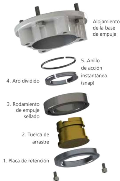
Fig. 5.1.2 Montaje de base F10
