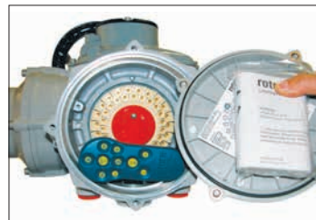
Fig. 7.3.2 Vano morsetti dell'attuatore e strumento di configurazione professionale Bluetooth (imballaggio a parte nella confezione della spedizione)
