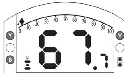
図 4.4.4 Torque (A) + Position (デジタル開度とアナログトルク表示)
