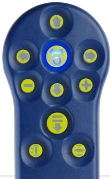
ロトルクBluetooth®設定器Proは下図のキーで構成されています。
