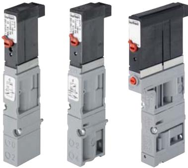
Die Pilotventile vom Typ 6524 und 6525 bestehen aus einem Vorsteuer-Flippermagnetventil vom Typ 6144 und einem Pneumatiksitzenventil. Das Wirkprinzip erlaubt das Schalten hoher Drücke bei geringer Leistungsaufnahme und mit kurzen Schaltzeiten. Die Vorsteuerventile sind serienmäßig mit einer Handbetätigung ausgestattet.
